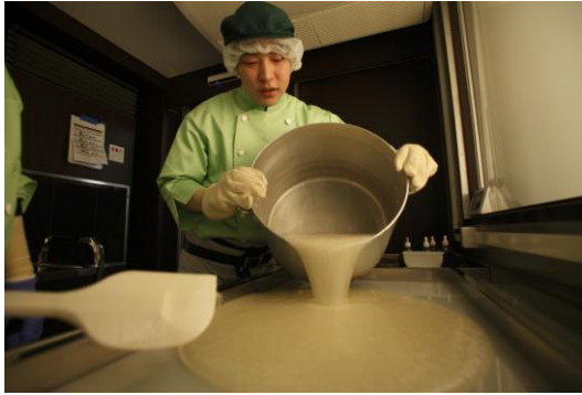
👉 熱した大型ステンレス板の上に飴を流します。
